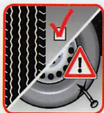
Provjerite profil guma i odsutnost štete (napuknuća)
